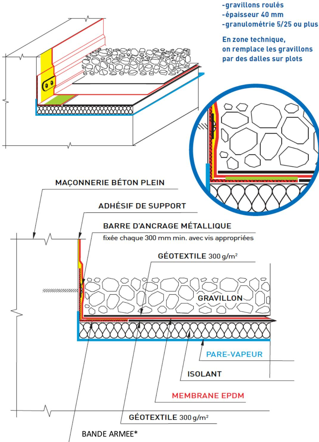
\*La bande armée peut être fixée à travers l'isolant directement sur le support bois ou béton avec des rupteurs de pont thermique, nous consulter.
